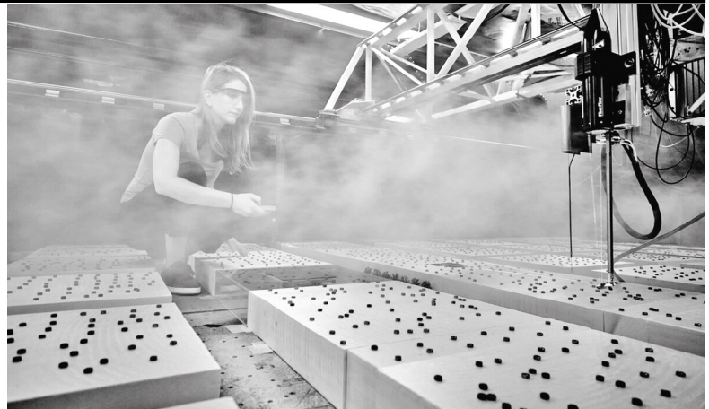
Expérience en soufflerie atmosphérique sur l'effet de la végétation sur la dispersion des polluants au sein une géométrie urbaine idéalisée (représentée par des blocs espacés régulièrement), représentative des villes Européennes @ Vincent Moncorgé - École Centrale de Lyon
